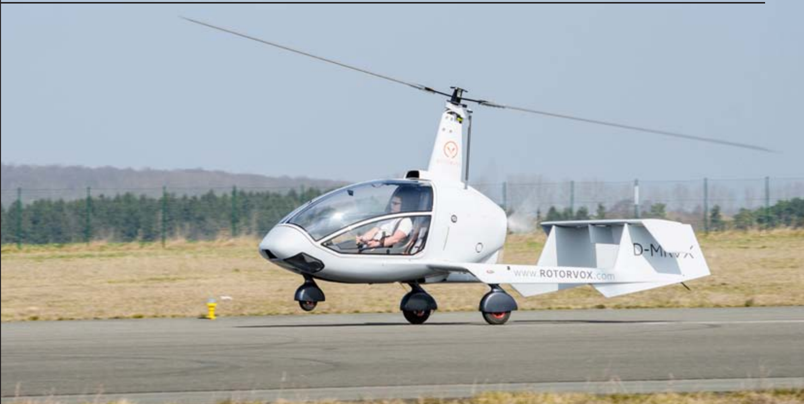
Rotorvox 旋翼机安装了预旋器，因此起飞距离非常短，降落也可以几乎像直升机一样垂直下降
