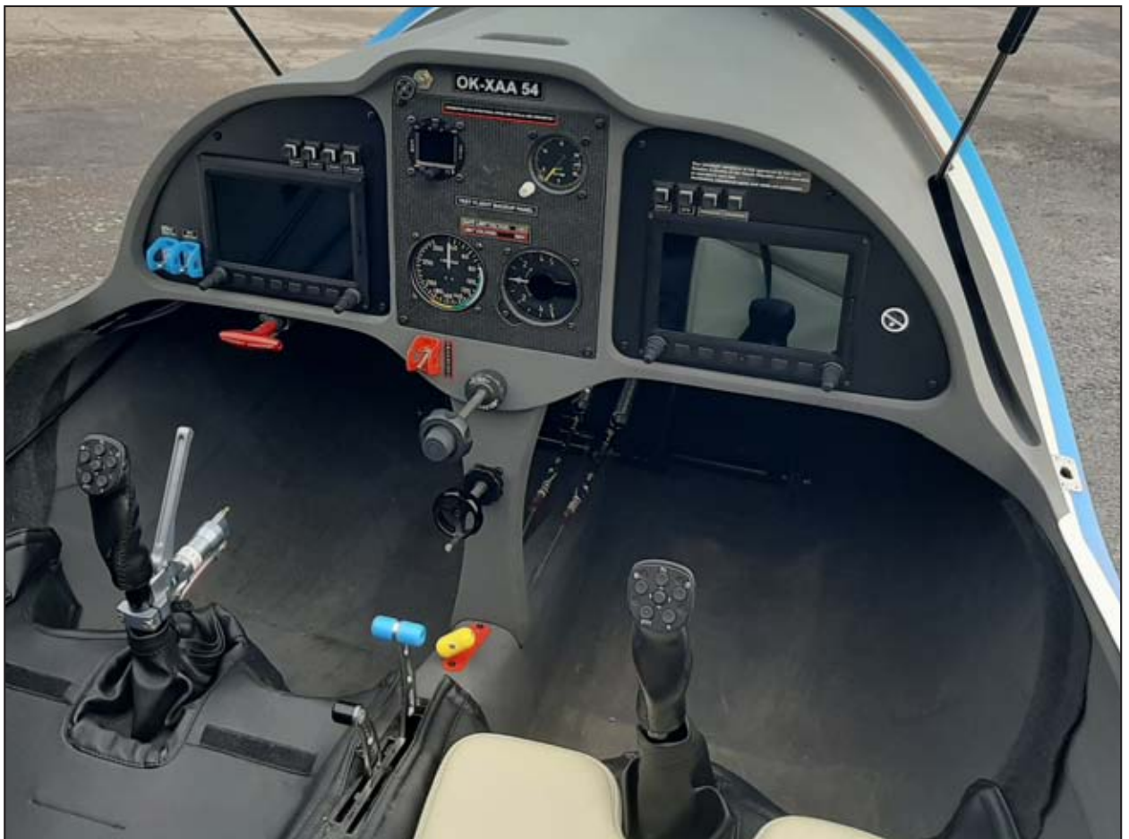
带有所有控制和显示功能的驾驶舱均基于 Rotax 型号，因此经过培训的飞行员可以轻松在油动和电动型号之间转换。LXNav 的两个玻璃显示屏：左侧是飞行仪表和（可选）导航，右侧是发动机仪表，并与 Rotax 航发或 MGM-Compro / Rotex 电机匹配。
