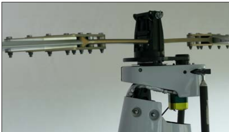
Rotorvox 的铝制旋翼头，安装了预旋器
