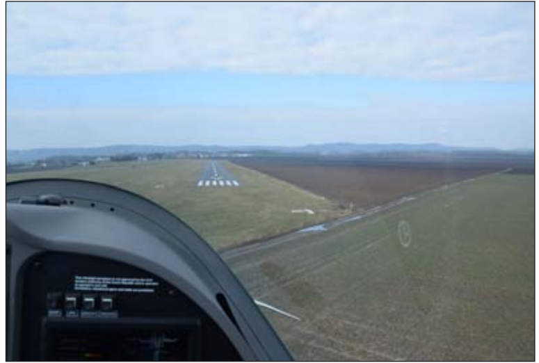
借助襟副翼和气动刹车, 可以实现精准着陆, 图中机头右侧可以看到顺桨位置的螺旋桨。
