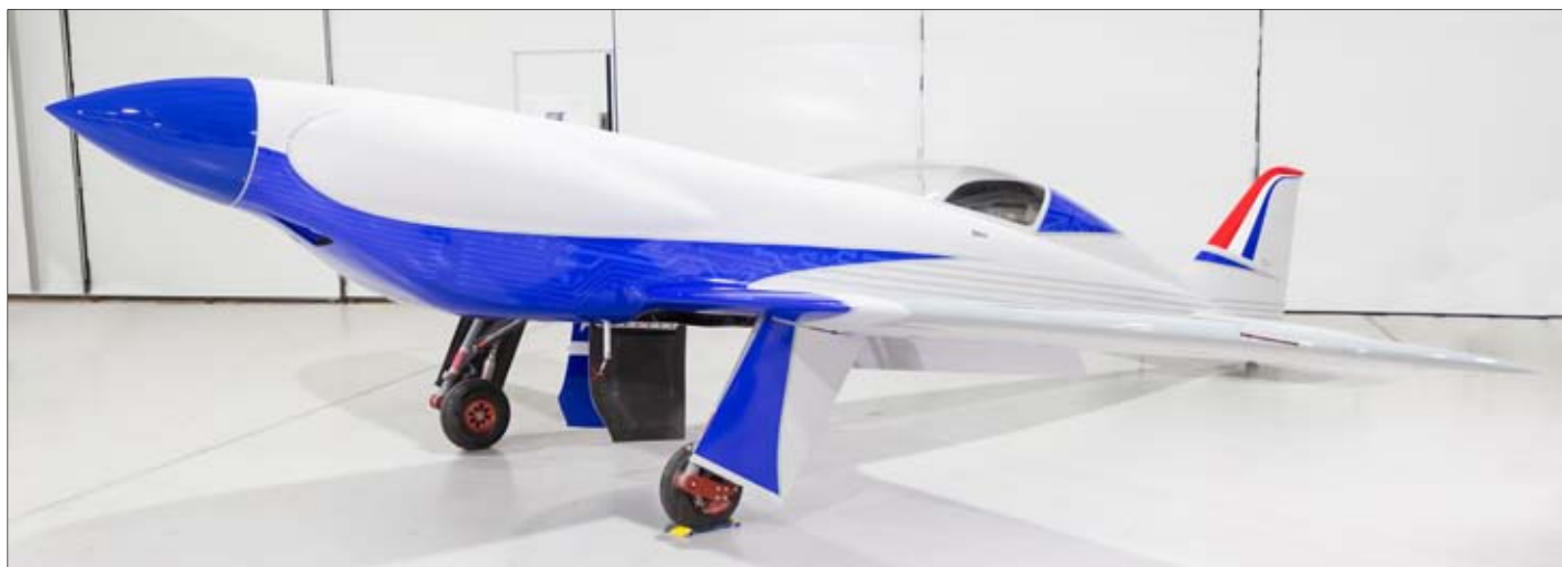
ACCEL 项目：这架号称“创新精神”的电动验证机是罗罗 ACCEL 计划的一部分，即“加速航空电气化”的简称
