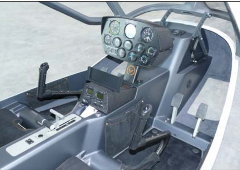
该机座舱视野优良，有大面积的座舱玻璃，脚部也有玻璃，非常适合巡逻监测用途
