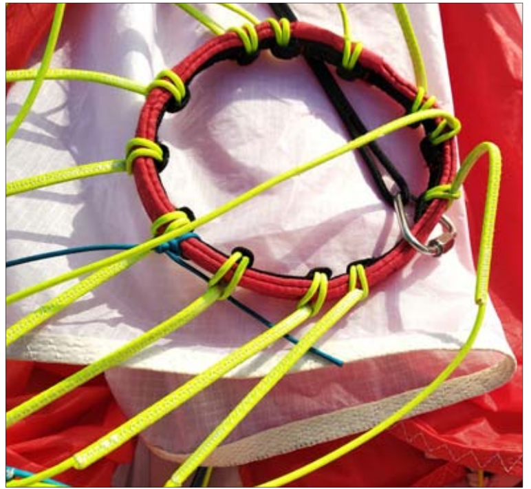
连接气囊和吊篮的缆绳：外观精美，通过了数吨的承重测试。
