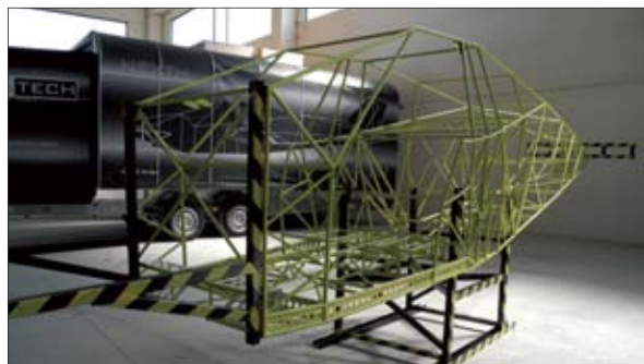
机身框架由 15CDV6 合金制成，这是一种低碳钢，与 4130 钢相比，具有更高的屈服强度、韧性和可焊接性。座舱有高强度乘员区
