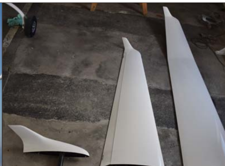
短机翼，可提供更多操作和更好的培训。图中是带有短翼梢小翼的 Phoenix 912 型号。有三种长度的翼梢小翼可供选择，翼展从 11.15 和 17 米。
