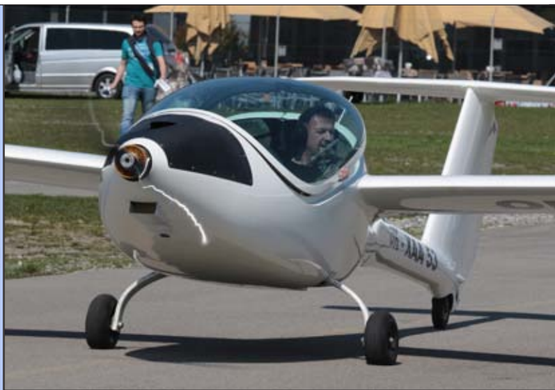
Phenix Electra 1：这架电动飞机的原型机是为 2011 年 NASA 绿色飞行挑战赛设计的，具有可收放起落架和 Discus 滑翔机的机翼。
