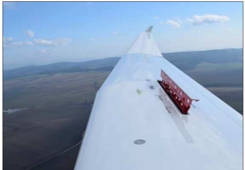
尽管滑翔比超过 30, 但由于采用了跟滑翔机一样的气动刹车, 仍可实现精确着陆。
