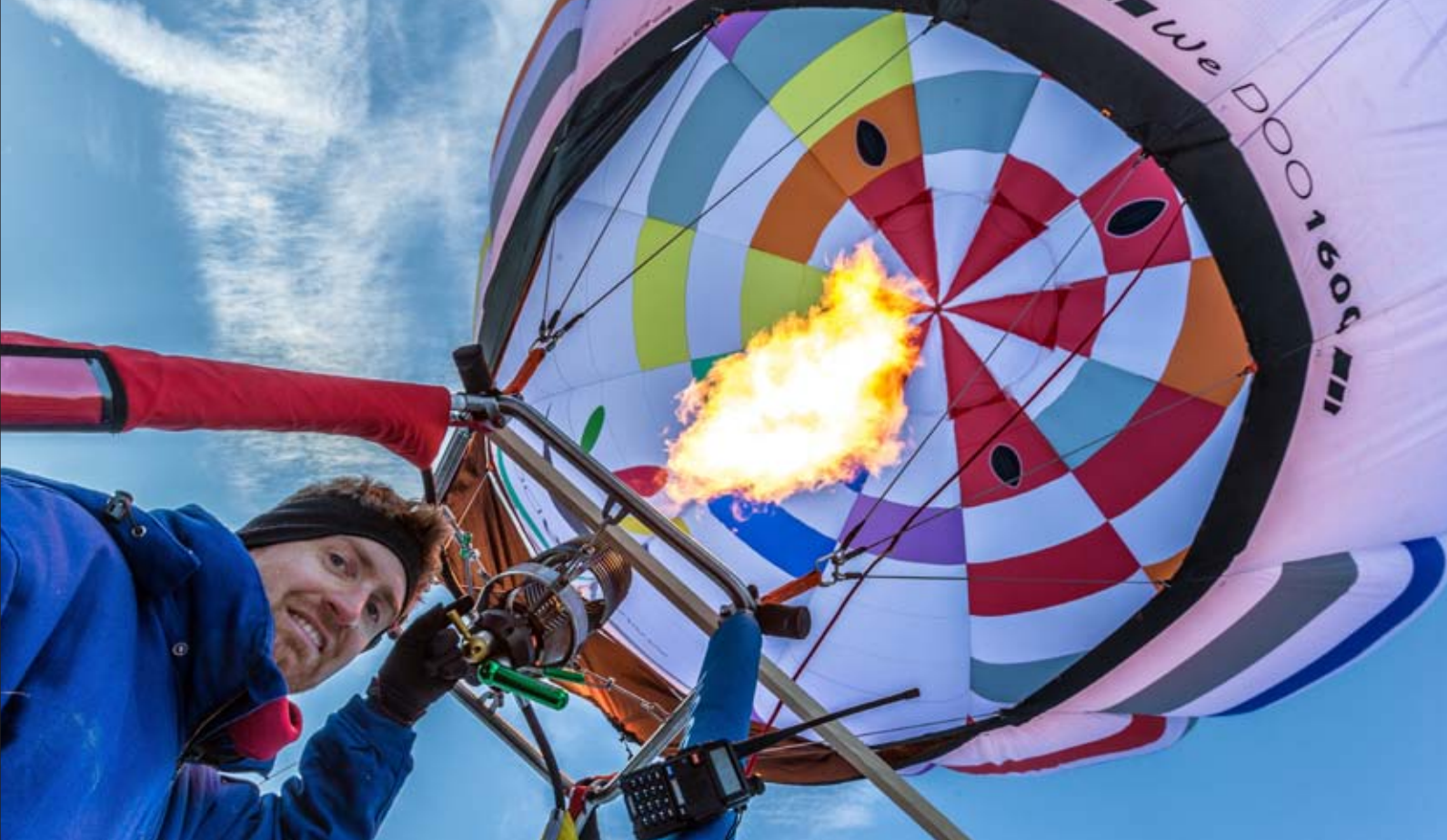
FlyDOO 的设计师莱安德罗·克拉迪尼正在为气囊加热。1600 立方米的气囊仅重 35 公斤，采用 Porcher Sport 公司的 Skytex 织物制成，该织物每平方米仅重 38 克
