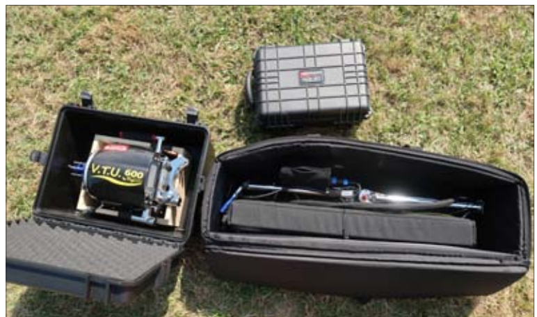
VTU 动力装置的电机、螺旋桨、电池和控制器可收纳在三个袋子里
