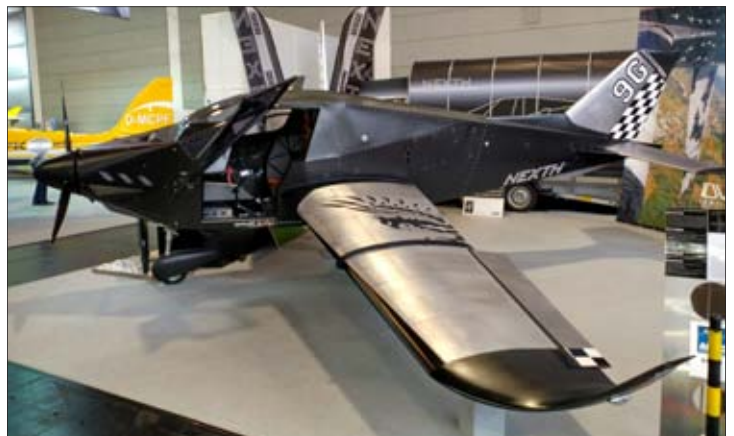
机翼较低，位于座舱后方，以确保良好的视野并方便进出座舱。
