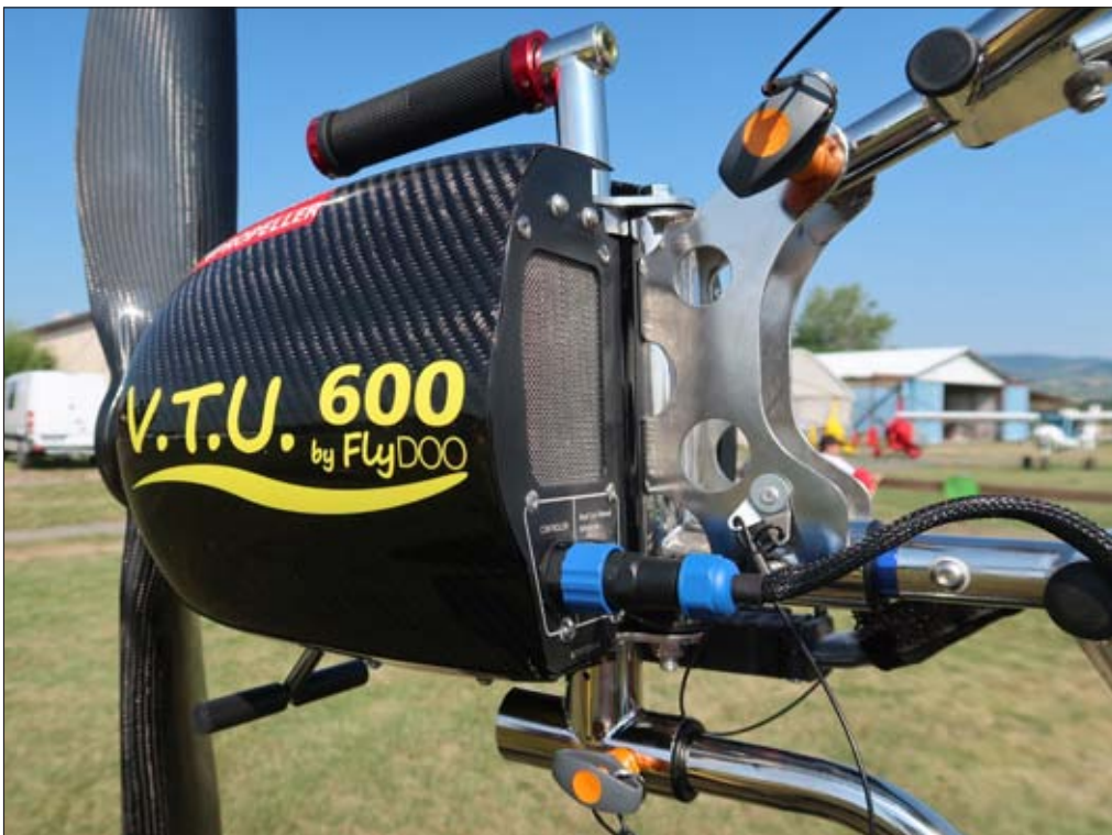
利用矢量控制的 VTU 动力装置，可以朝预定航向施加推力，从而控制 FlyDOO 的航向或落点。
