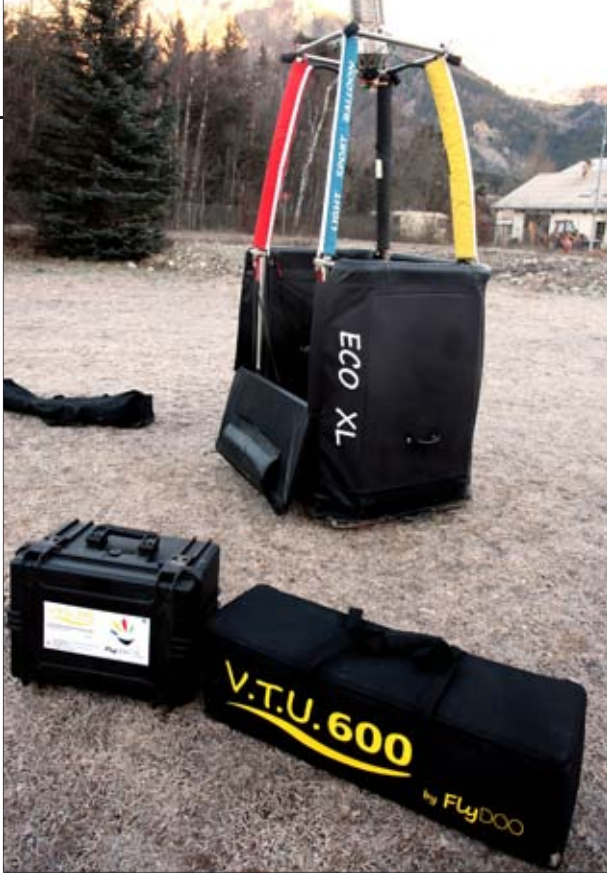
几分钟即可安装完毕：可容纳两个人的 Eco XL 型号吊篮，前面是装有 VTU 动力装置的袋子
