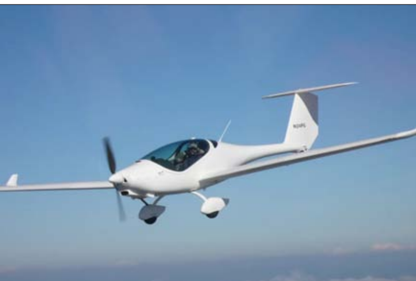
短机翼，可提供更多操作和更好的培训。图中是带有短翼梢小翼的 Phoenix 912 型号。有三种长度的翼梢小翼可供选择，翼展从 11.15 和 17 米。
