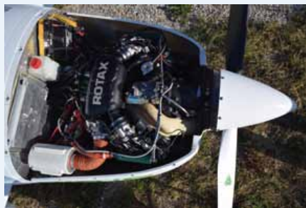
蝙蝠飞机公司的“病毒”动力滑翔机安装的新型 912 运动型发动机，铝制的进气道能提高扭矩并降低油耗
