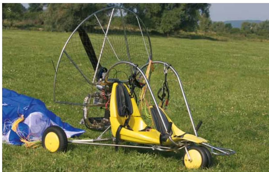
1 FunFlyer 双座动力伞在无风条件下也能轻松起飞 2 采用一台意大利 Simonini 50 马力发动机 3 动力小车体积小巧，便于运输
