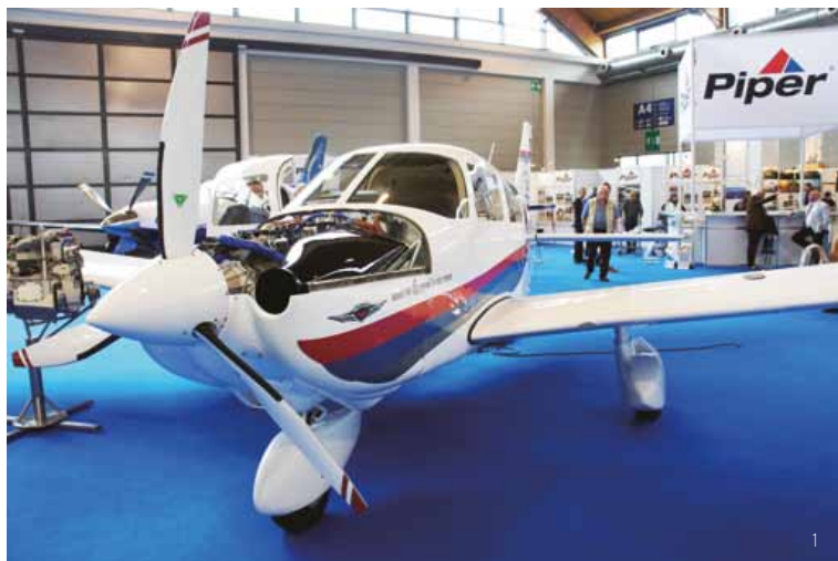
1 老当益壮的新型动力派柏 PA-28。派柏公司在此次 AERO 开展前一周刚获得了安装德国 Thielert 公司的 Centurion 2.0 航煤发动机的最新型 PA-28 DX 飞机的欧盟适航认证，油耗较同样性能的汽油发动机型号降低了 90%
