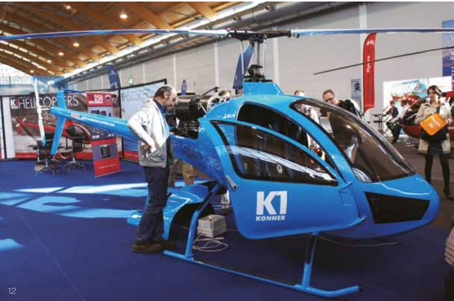
12 意大利 Konner 直升机公司的最新型 K1 双座超轻型直升机及配套的该公司自主研制的 250 马力涡轴发动机 13 节能环保已经成为德国民众的惯常生活方式，影响到小飞机行业也就是自然而然了。作者此次居住的德国乡间旅社屋顶上布满太阳能电池板，如果电量自用有余，可以卖给电网公司
