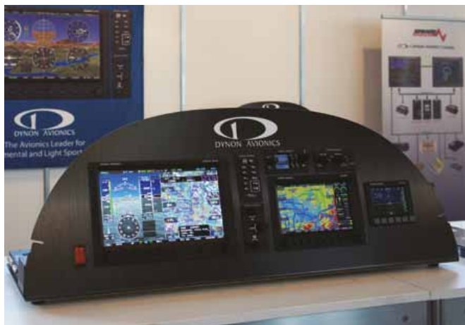
Dynon 公司的 Skyview 触屏航电仍然保留了传统的控制旋钮，以便飞行员在乱流中容易控制
