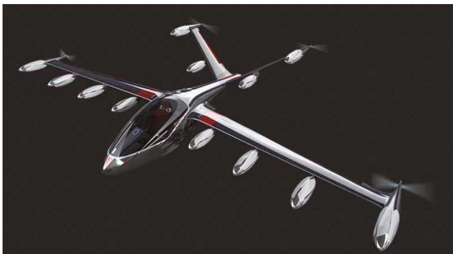
美国硅谷地区的 Joby 公司设计的 S2 电动矢量飞机，12 个电机可以做九十度变向，垂直起飞后电机变向为水平巡航状态，部分旋翼折叠以降低阻力
