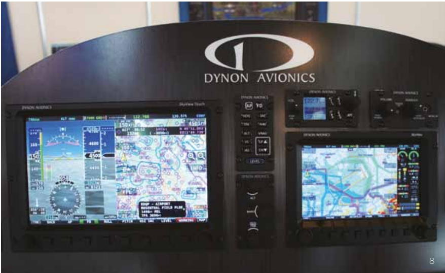
8 美国 Dynon 公司的 Skyview 触屏一体化数字航电，仍保留了完整的操作按钮 9 佳明 G3X 触屏一体化数字航电，采用红外线触屏技术，戴普通手套也可以触屏操作 10 美国 Trutrac 公司的超小型一体化数字航电，包括了完整的飞行、发动机、导航和自动驾驶仪信息和功能操作 11 捷克 Brno 科技大学 AeroWorks 自动驾驶仪项目的研制团队
