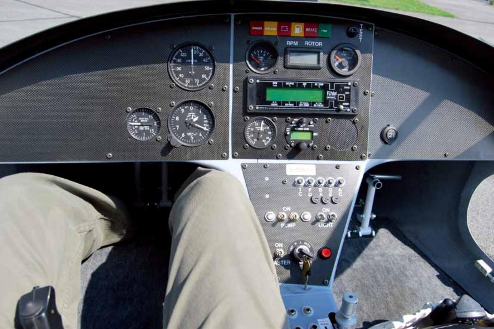
仪表盘：所有需要的仪表都已经在内。飞行员左侧是高度计，速度表和升降速度表。中部是数字显示的旋翼转速表以及下方的显示所有发动机数据的 Rotax FLYdat 仪表盘。中间的托架上主要是电子系统以及停机刹车。节气阀和预旋制动器都被布置在机舱中间托架上飞行员的那一边
