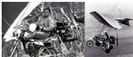
Mainair 摩托与悬挂三角翼相结合的飞行汽车
