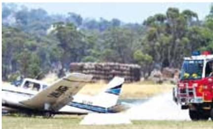
2013 年 1 月 7 日，一架出现故障的 PA-28 Warrior 在墨尔本以北 150 公里的门戈洛尔安全着陆。机场发言人贾格拉表示，飞机起飞后机场工作人员发现一个起落架轮脱落，而飞机上只有一名年仅 21 岁的南航学员，迫降的过程中学员使用英语与地面交流，为了防止歧义误解，偶尔会与同学和教官用汉语交流。为了防止降落出现摩擦起火，飞机在空中飞行了 4 小时将燃油耗光后才在跑道上蹒跚着陆，随即灭火队立即向飞机周围喷洒泡沫。维多利亚州急救组织及时对学员作了检查和治疗，除了轻微的振动伤害外，无其他显著伤害。出故障的飞机于 1975 年出厂，此前的维护记录显示适航，此类起落架轮脱落事件从未在该机场出现过，是非常少见的一种事故。
