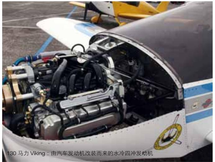
130 马力 Viking : 由汽车发动机改装而来的水冷四冲发动机
