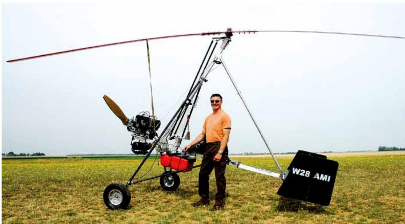
现在仍有旋翼机采用“Bensen”技术，就像有趣设计的 Pascal Olino 旋翼机那样。Olino 采用很少用于旋翼机的牵引机构型。AMI W28 机型装配一台 Rotax503 发动机，一个 7 米长的 McCutchen 转子和尾轮起落架装置
