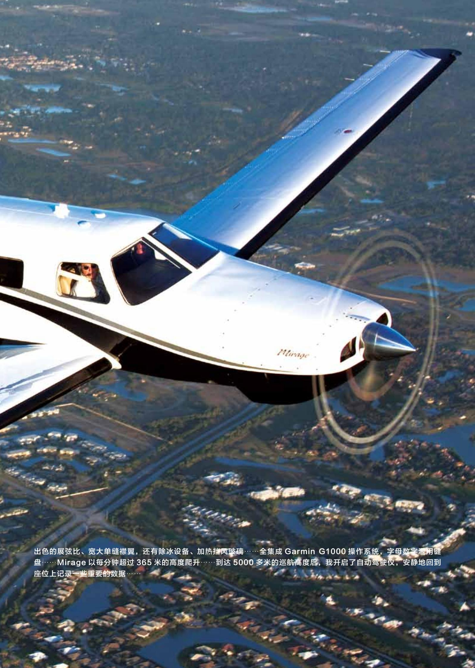
出色的展弦比、宽大单缝襟翼，还有除冰设备、加热挡风玻璃……全集成 Garmin G1000 操作系统，字母数字混用键盘……Mirage 以每分钟超过 365 米的高度爬升……到达 5000 多米的巡航高度后，我开启了自动驾驶仪，安静地回到座位上记录一些重要的数据……
