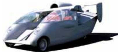
奥地利人约翰·布朗研究了多年飞行汽车的发展史后，当决定研制 Tarpaulin 飞行汽车时，他试着避免重复过去一百年中飞行汽车失败的教训。飞行汽车面临的因素很多，比如地面行驶的振动、足够的升力、飞机和汽车所需的不同的操纵机构等等。该飞行汽车还未决定将采用的动力系统。选择之一是用一台 Rotax912 发动机用于飞行，另一台内燃发动机或一台电动机用于地面行驶。另一个选择是从头研发一个传动系统，用一台直列气缸发动机驱动螺旋桨用于飞行，同时通过一个专门设计的传动系统来驱动车轮在地面行驶。德国的下萨克森州和欧盟资助了该飞行汽车研发项目，预计 2014 年首飞，2015 年量产。目前还尚未有关于这架双座的轻型运动飞机类别的飞行汽车的进一步报道。网址：[www.carplane.com](http://www.carplane.com)
