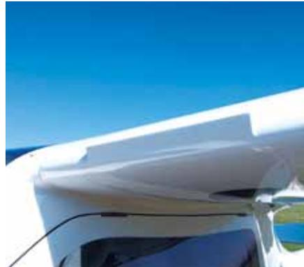
两个小型前缘缝翼能延缓大迎角时流过内侧机翼的气流的分离, 防止大迎角下飞机失速
