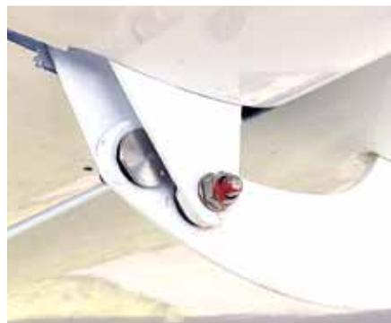
襟翼铰链和副翼插槽。这两个组件被同一操纵杆控制
