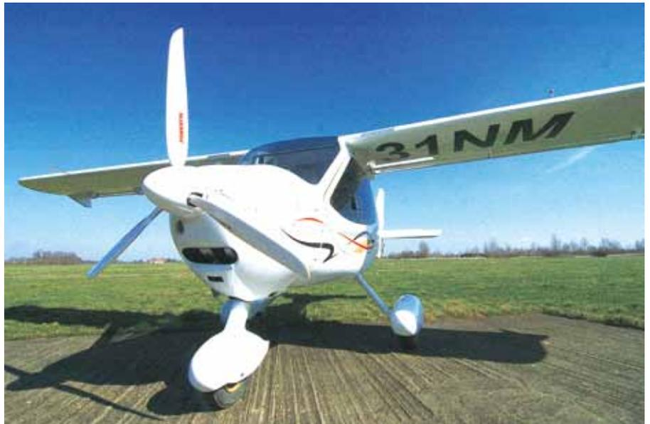
呈现笑脸模样的飞机前脸。CT 飞机较大的机头并没有增大阻力，反而提升了飞机性能
