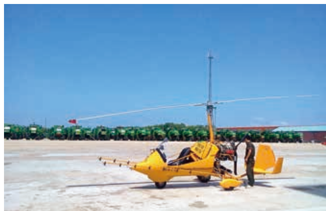
西安中联采用西班牙 ELA 自转旋翼机型实施农化作业
