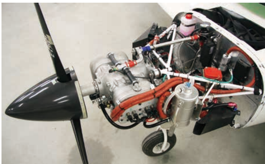
Ellipse 安装的 D-Motor 发动机
