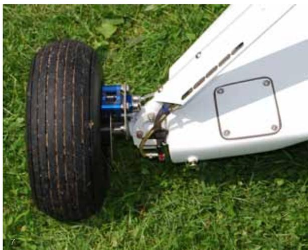
7 4 英寸机轮和液压刹车装置也是由 Rotortec 生产
