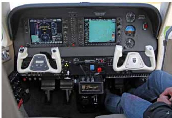
以根据实际情况进行调节。与所有配置了玻璃座舱的飞机一样，仪表板通过显示器进行控制。右外侧垂直排列了三台必须的备用仪器，这样的设计在紧急情况下显然是不利的。此外，仪表板上还装配了液体罗盘。
