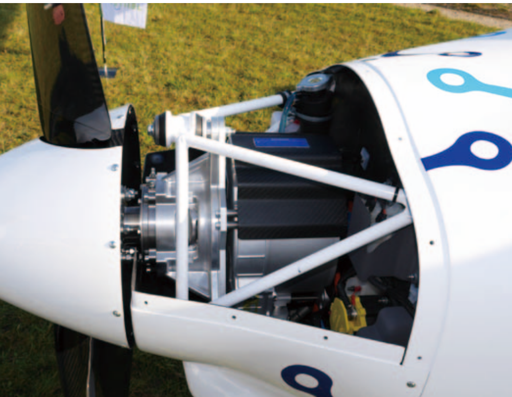
重 14 千克，功率 85 千瓦的电动马达比 Rotax 912 系列发动机动力更足，一般用在超轻微型和轻型运动飞机上
