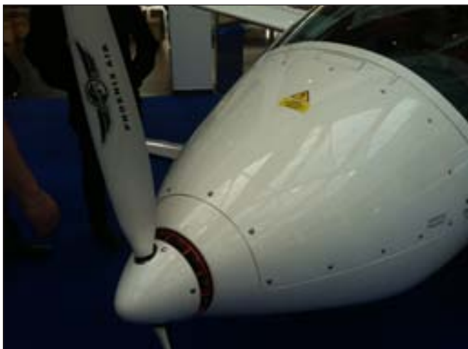
Der elektrische Phoenix wird einen 60 KW-Motor verwenden und zwei Stunden Flugzeit haben.
