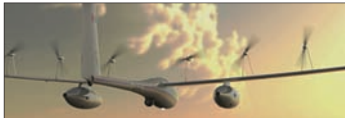
Der Lange Research E2 - fliegt 40 Stunden dank Brennstoffzelle.
