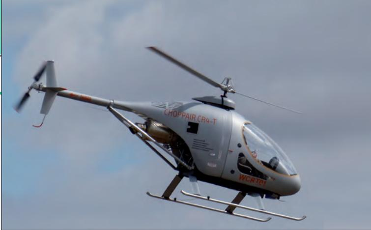
使用 TP-R90 涡轮发动机的 Choppair CR4-T 直升机已经飞行了许多小时。
