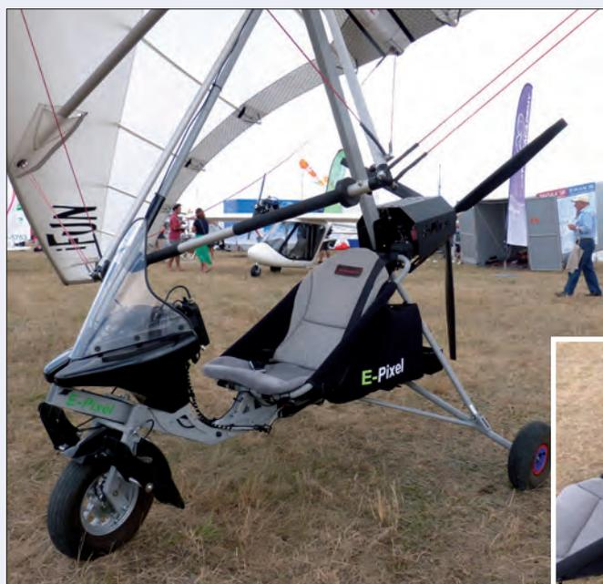
法国制造商 Air Création 今年还推出了其单座动力三角翼的电动版 E-Pixel，也配备了 Geiger HPD20 电机，并由 E-Props 的三叶螺旋桨推进。
