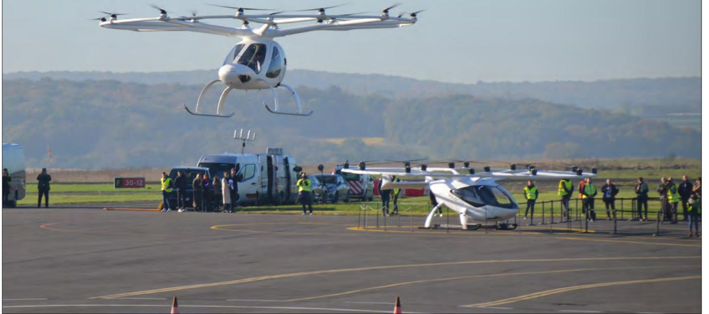
在蓬图瓦兹机场的展示飞行。虽然 Volocopter VC 200 和 2X 两个机型获得了德国的超轻机认证可以飞行，但 Volocity 仍必须留在地面上。
