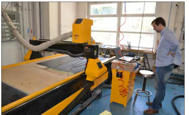
使用 CNC 激光切割机切割翼肋。
