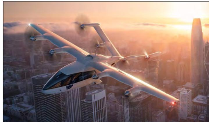
采用了滑橇起落架。此外，单尾取代了之前的双尾。以前用于巡航飞行的推进式螺旋桨也取消了，从原来的复合翼构型改为倾转翼构型。 [www.wisk.aero](http://www.wisk.aero)
