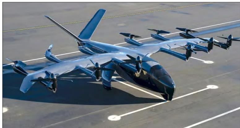
司发布的空中出租车“午夜”原型机与该机采用相同的构型，与 Maker 一样，“午夜”电动 eVTOL 代表了倾转旋翼和复合翼构型之间的结合构型，由一名飞行员驾驶，四名乘客。设计者计算出的有效载荷刚好超过 450 公斤。然而，该机还有很多需要改进之处。公司声称，该机针对往返约 30 公里的目的地的空中旅行进行了优化设计，两次飞行之间的充电时间只需十分钟。·www.archer.com
