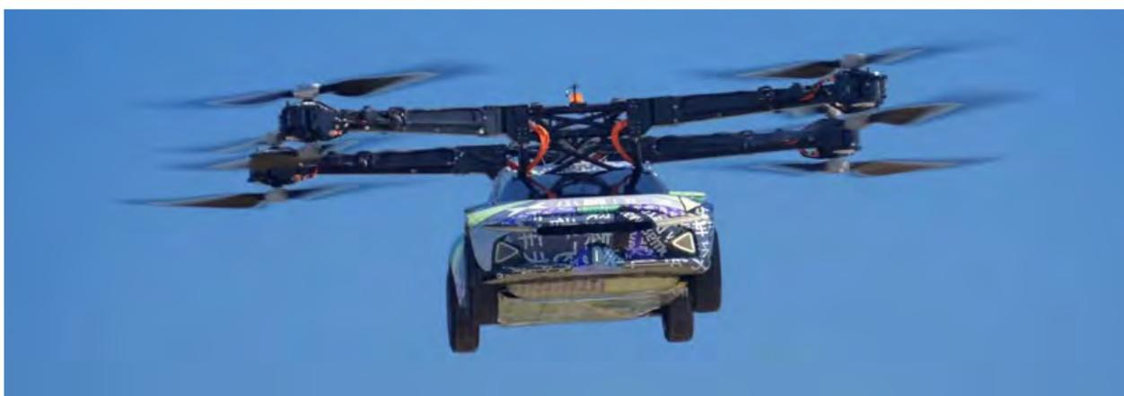
电动车公司小鹏汽车的子公司汇天航空航天科技最近在迪拜进行了双座 eVTOL X2 的演示飞行后，公布了第二个项目的设计，即电动飞行汽车。安装在车顶的折叠式八轴多旋翼器系统可以将豪华跑车带到空中。现已发布的一段视频证明，重达近两吨的验证机确实飞起来了。目前设计使用了一个更紧凑的 VTOL 系统，对置螺旋桨组件
