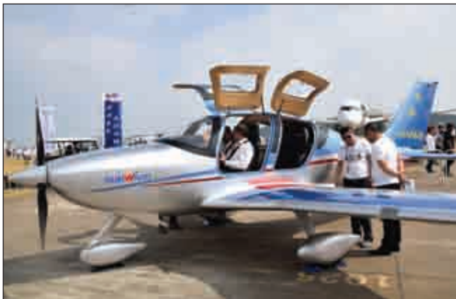
湖南山河科技公司研制的 SA160 五座新型飞机采用了碳纤维结构 的复合材料
