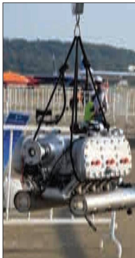
比利时的 D-Motor 公司用最直观的方法展示其六缸活塞航发的重量
