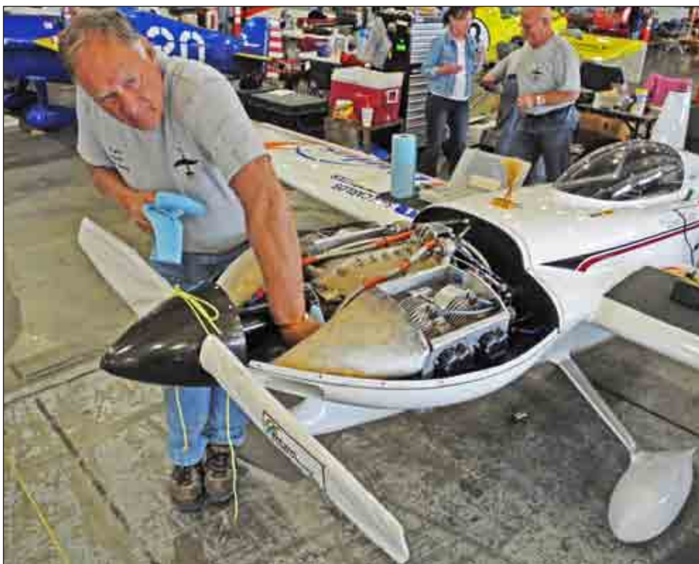
机务人员正在维护 F1 级参赛飞机”Fraed Nought “号的大陆 O-200 发动机，注意看长长的螺旋桨延长安装轴
