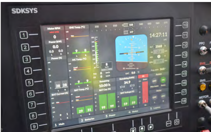
显示器是一台符合军用安全标准的高性能计算机：它有导航、电机监控和DAP等功能，后者监控飞机状态、记录数据并实时传输。
