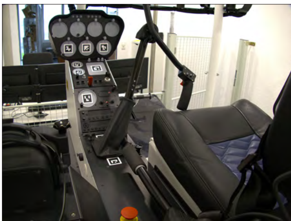
R22 模拟器具有跟真机一样的操纵系统
