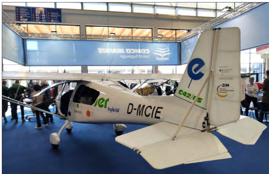
Ikarus 公司改装的采用燃料电池电推的 C42
