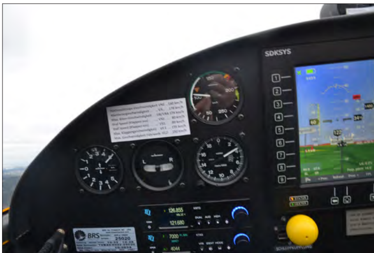
显示器是一台符合军用安全标准的高性能计算机：它有导航、电机监控和DAP等功能，后者监控飞机状态、记录数据并实时传输。
