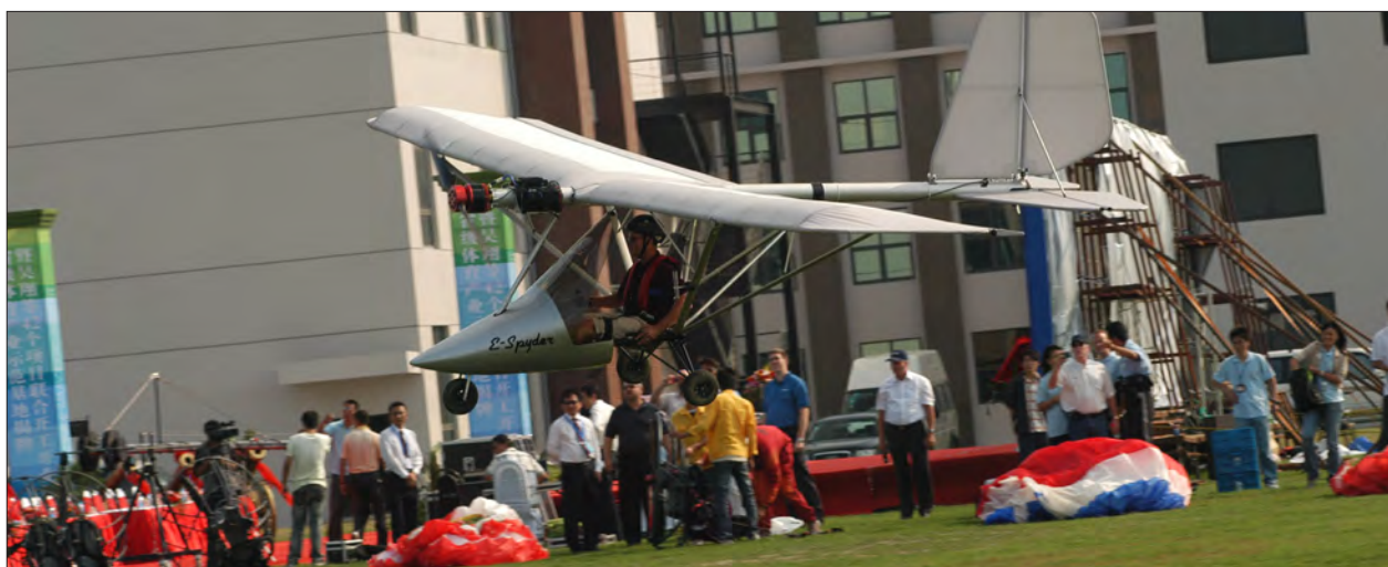
峰飞的电动航空之路：田瑜研制的 eSpyder 单座电动超轻机，2009 年在上海首飞，该机获得了德国的超轻机适航认证
