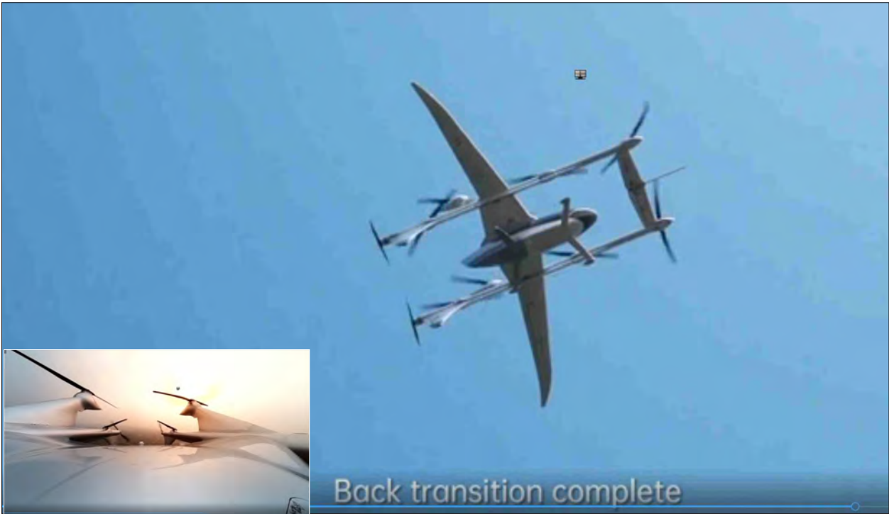
V1500M 原型机已开始进行垂直起降与水平巡航的姿态转换试飞
