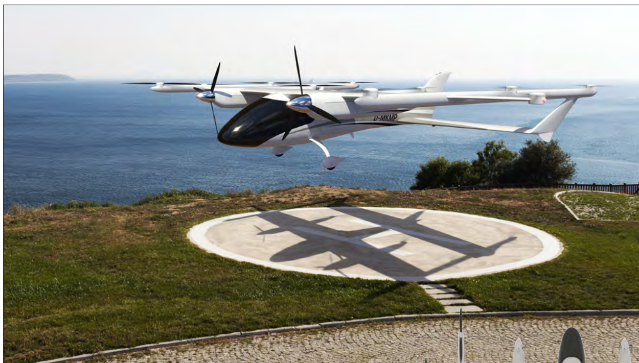
eMagicNext 将采用 10 个升力螺旋桨用于垂直起降
