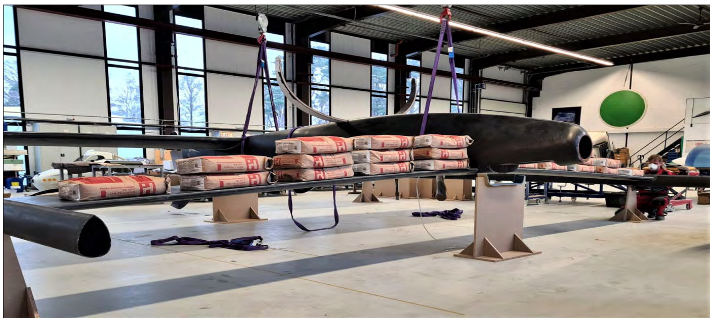
从一开始就安全至上：结构的负载测试。eMagic One 从一开始就按照德国 LTF UL 超轻机认证要求进行设计
