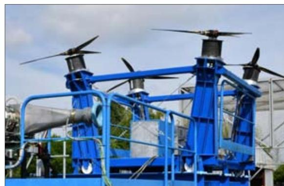
自去年 6 月以来，赛峰的 HEPS 混合动力系统已投入地面测试，功率输出达到 100kw (照片来源：赛峰)
