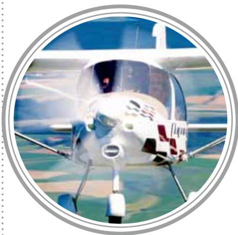
我们从测试巡航速度开始，这也是 C52 肯定会被竞争机型比较的数据。在大约 4000 英尺 (1219 米) 的海拔高度，发动机缸压 2.45in/Hg，转速每分钟 5000 转，这是 75% 的发动机功率设定值，我们飞了三个航段，平均巡航时速是 193 公里。在座舱中你面对的是熟悉的环境，但其实你所飞的是全新的 C52 飞机，它的气动外形经过了优化改进，与其他管构蒙布的超轻飞机相比，C52 的性能水平独树一帜。发动机转速增加到每分钟 5300 转的最大功率时，C52 的空速达到了令人吃惊的每小时 220 公里，最大允许时速是 236 公里。即使是 4800 转 65% 的功率时，平均时速也有 182 公里。速度是一方面，另一个性能表现是推杆后，C52 只上下波动了一次就恢复了平飞。
