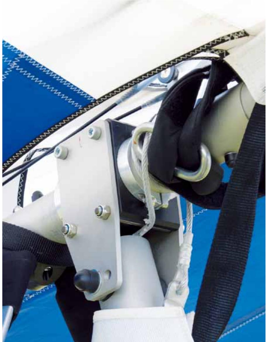
动力三角翼 - 在飞重心控制的飞行器的时候（例如动力三角翼）飞行员通过改变重心和压力中心的相对位置来操纵。前推 A 形架会使重心移到压力中心后面，三角翼会爬升。后拉 A 形架则使重心移到压力中心前方，三角翼会下降
