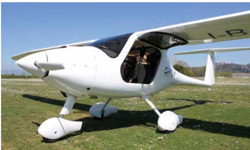
Sinus 机身的设计特点包括：短而精的机头、宽敞的座舱，以及配有 T 型尾翼的机尾。其座舱的设计则秉承了 Pipistrel 公司“安全驾驶舱概念”——座舱结构采用了凯夫拉纤维材料加固，在发生撞击时可以很好地吸收能量
