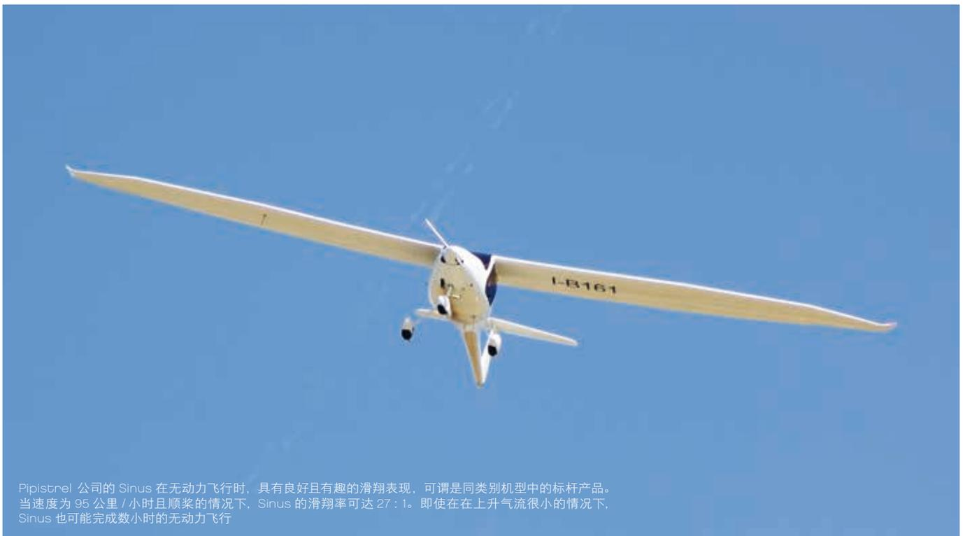
Pipistrel 公司的 Sinus 在无动力飞行时，具有良好且有趣的滑翔表现，可谓同类机型中的标杆产品。当速度为 95 公里 / 小时且顺桨的情况下，Sinus 的滑翔率可达 27 : 1。即使在上升气流很小的情况下，Sinus 也可能完成数小时的无动力飞行。
