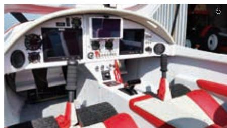
也很容易。舱盖上配有遮阳板，该遮阳板还具有支撑功能，能够增加飞机的结构稳定性。在紧挨着两个皮制驾驶员座椅后方是宽大的行李放置区，可以容纳 15 千克的行李。另外，作为可选配置，Pokospol 公司不久还会提供机翼内置物品存放空间，就位于飞机的重心位置所在之处。其余的内饰部分设计上非常具有整体感。作为操控整个飞机的核心，D-MROF 仪表外部整体覆盖有白色塑料保护壳。虽然这样设计只是为了美观，但它确实能够使驾驶舱看起来与众不同。然而真正赢得我喜爱的则是左右各一的座椅扶手以及两个座位之间的可折叠式（中间）扶手。左右两侧各有一个出风口为机长和副驾驶提供新鲜空气。如果买家有需求，还可以在头顶部加装出风口。无论乘坐在哪一个座位都会感到非常舒适。
