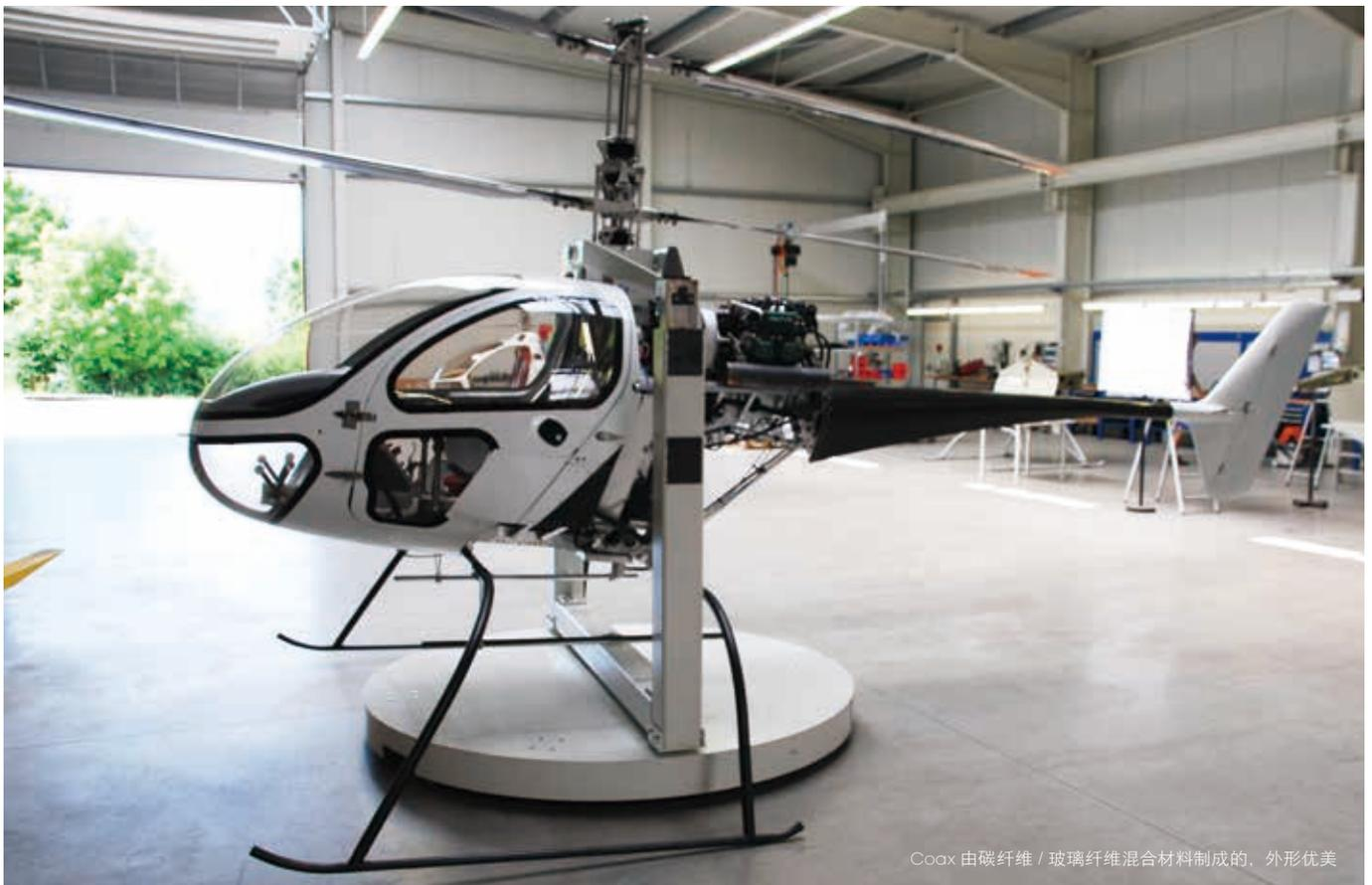
Coax 由碳纤维 / 玻璃纤维混合材料制成的，外形优美
