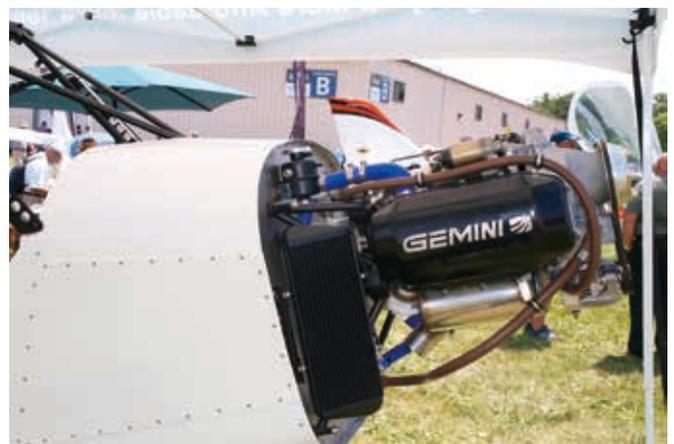
发动机制造商 American Legend Aircraft 公司将会为他们提供一款 100 马力的 Gemini Diesel 柴油发动机，作为 Superior 公司 Legend Cub 轻型运动飞机的（制造厂）可选发动机配置
