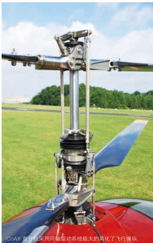
CoAX 直升机采用同轴驱动系统极大的简化了飞行操纵
