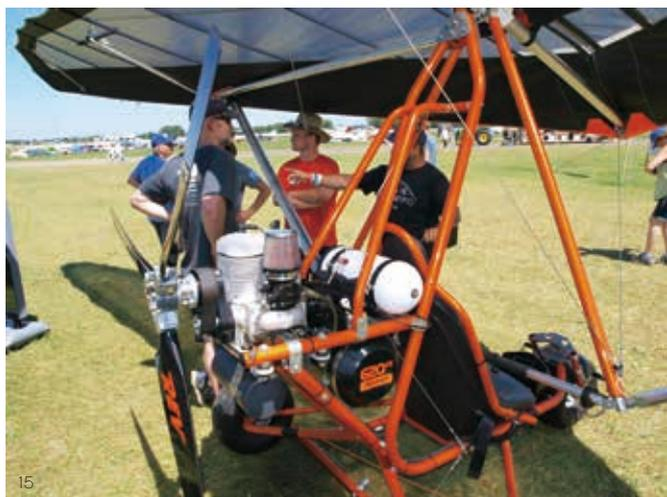
15 这次 Revo 公司将一款十分有趣的轮式飞机带到了 AirVenture 大会。这款名为 Revolver 的三轮式飞机采用了单座布局，搭载两冲程 MZ 发动机
