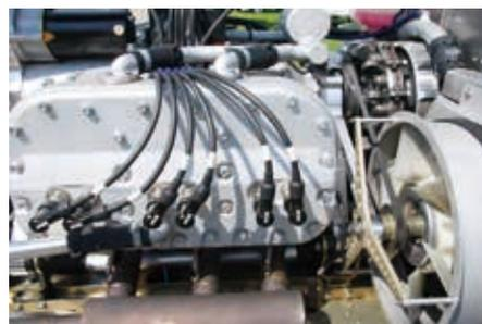
EDM AEROTEC 公司选择了比利时的“Dengine”公司生产的 LF 39 发动机采用了水冷六汽缸喷射式设计，具有接近 300 牛米的扭矩
