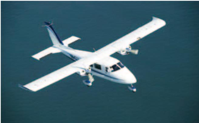
**P68C 系列**：安全、舒适，超长航程，装备两台莱康明发动机（200 马力 / 台），2+4 座位布局，常规机头。航程达到 3000 公里，续航时间 10.5 小时，可进行长时间飞行作业。原厂提供机腹开洞，是航空摄影、空中搜索、警戒巡逻、林区巡视、海岛旅游、私人公务飞行理想选择。
