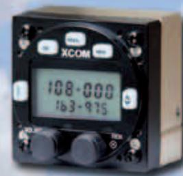
Xcom的可分离式控制面板非常适合于串联双座飞机，包括滑翔机、派柏Cub飞机等，前后座都可以控制电台
