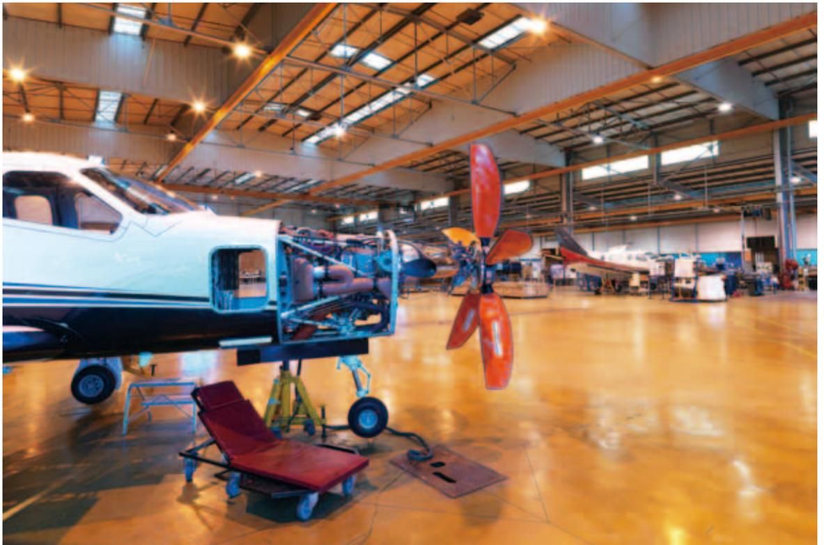
位于法国南部的制造基地，为普惠 PT-6 配套的整流罩主要由复合材料制成。螺旋桨为 Hartzel 出品
