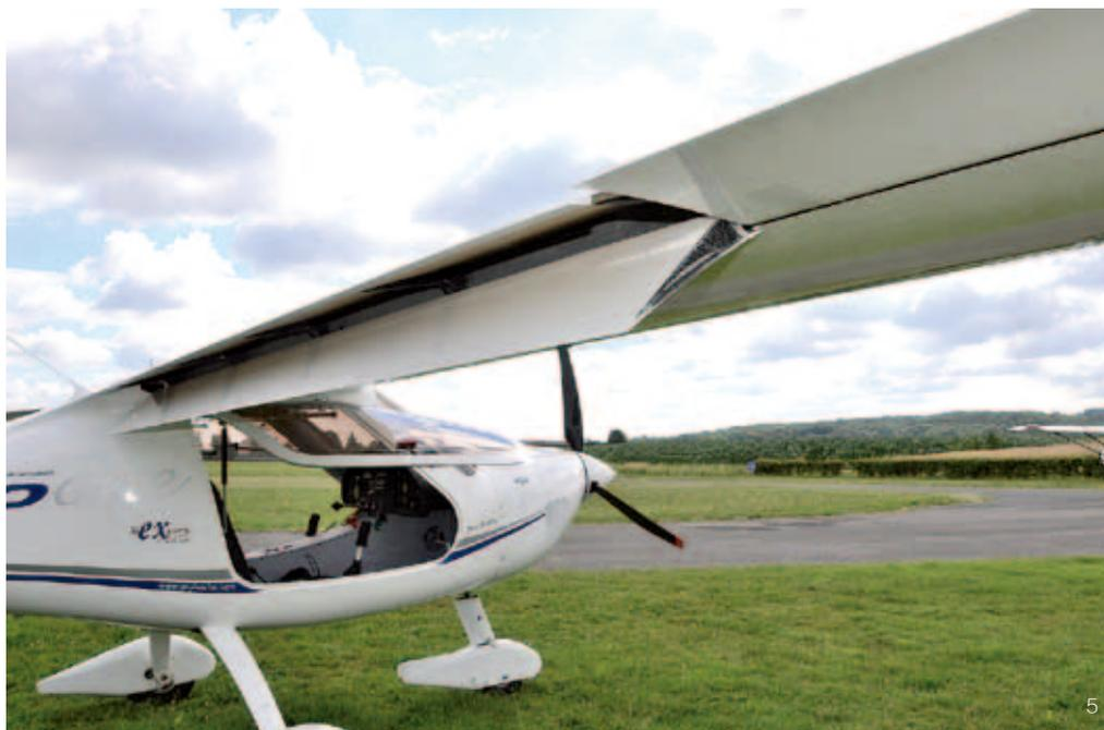
5. 高效率襟翼延伸超出翼展的 2/3。分离式襟翼设计技术上更简单，维护要求更低
