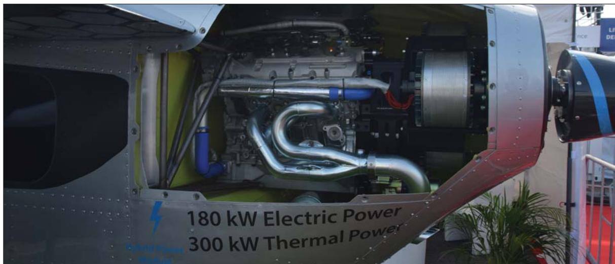
Cassio 1 验证机的混动电推系统采用一台内燃发动机和五台电机，后续机型将采用三台电机和一台内燃发动机的配置
