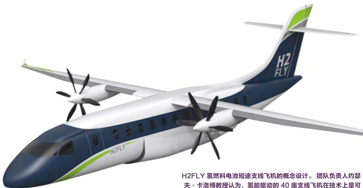
**H2FLY 氢燃料电池短途支线飞机的概念设计。团队负责人约瑟夫·卡洛博教授认为，氢能驱动的 40 座支线飞机在技术上是可行的，速度可以超过 400 公里 / 小时，航程可以达到 1 千公里。**
