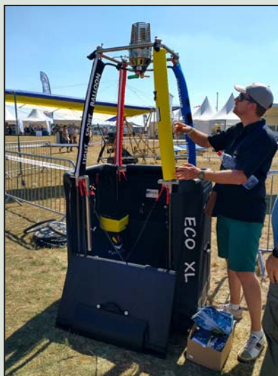
法国 Flydoo 公司研制的超轻型单人电动推进热气球，在单人热气球基础上加装了电机螺旋桨，有利于控制方向
