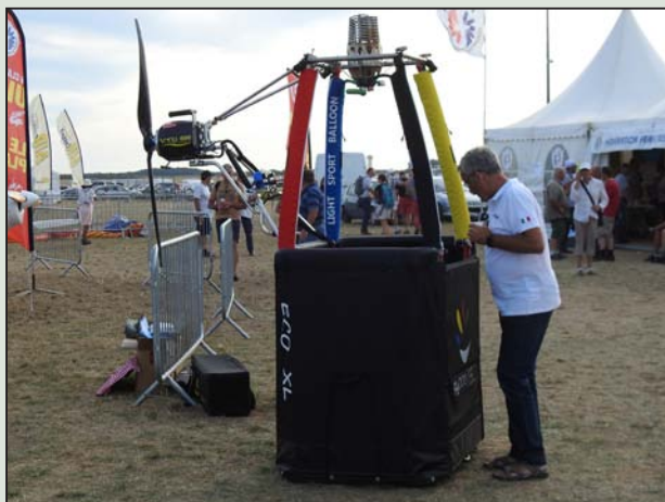
法国 Flydoo 公司研制的超轻型单人电动推进热气球，在单人热气球基础上加装了电机螺旋桨，有利于控制方向
