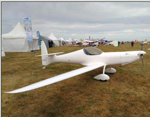
法国飞行员 Arnaud 用 5 年时间里在家里自行设计制造了这架名为 EXIA 的单座实验类飞机，目标是高效巡航，该机为碳纤维，使用 35 马力转子发动机，空重 133 公斤，失速速度 64 公里每小时，最大速度 210 公里每小时
