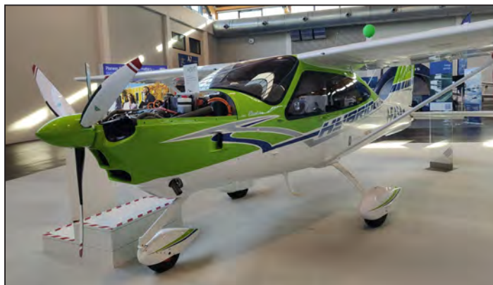
H3PS 混动电推验证机的发动机舱，采用一台罗泰克斯活塞航发加一台罗罗公司研制的专用电机
