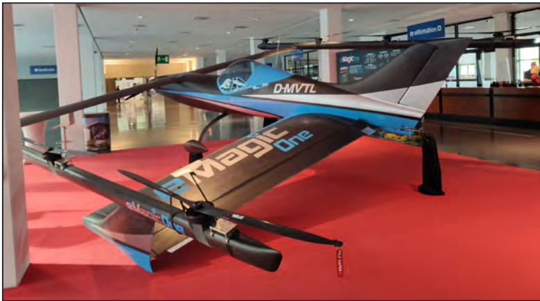
德国 eMagicOne 单座 eVTOL 复合翼验证机，该机在一年之内完成设计、制造和试飞。该机获得了本届电动航空奖。该机是参加本届航展的唯一一架 eVTOL 全尺寸整机。
