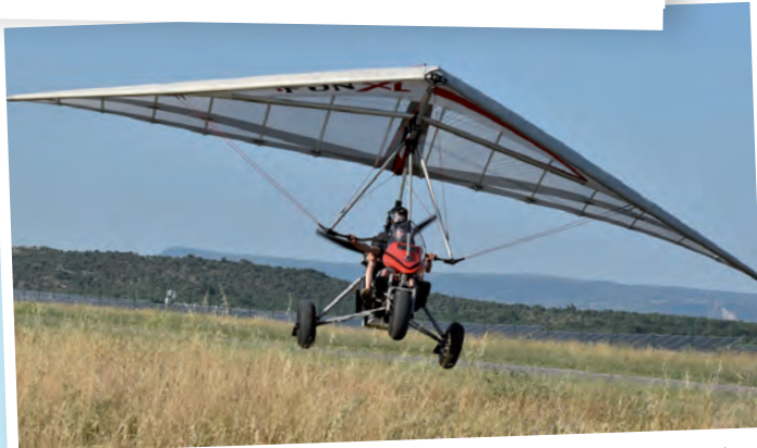
2021: 年: 使用 iFunXL 机翼的 Skypper Bush (18 平方米): 大面积机翼使这个双座型的最小速度几乎只有 50 公里 / 小时, 并能从崎岖地形中最短的斜坡开始起飞。
