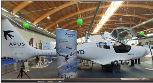
德国 APUS 公司的氢燃料电池验证机模型。该项目的合作伙伴专门研制了高强度的管状储氢罐，同时也作为机翼翼梁，共有 4 根，每根约 80 公斤重
