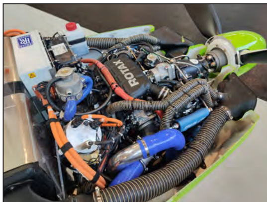
罗罗公司、意大利泰克南飞机公司和罗泰克斯公司合作研制的 H3PS 混动电推验证机。
