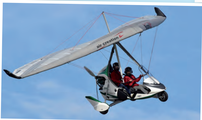
2019: Tanarg Neo : 新的座舱设计、整流罩、座椅和许多细节改进。使用 BoniX2 机翼, Neo 的最大速度可达 180 公里 / 小时
