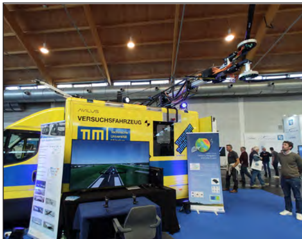
慕尼黑工业大学的电驱测试平台，全套系统整合在一辆轻型客车上，可以开展多种外场测试。
