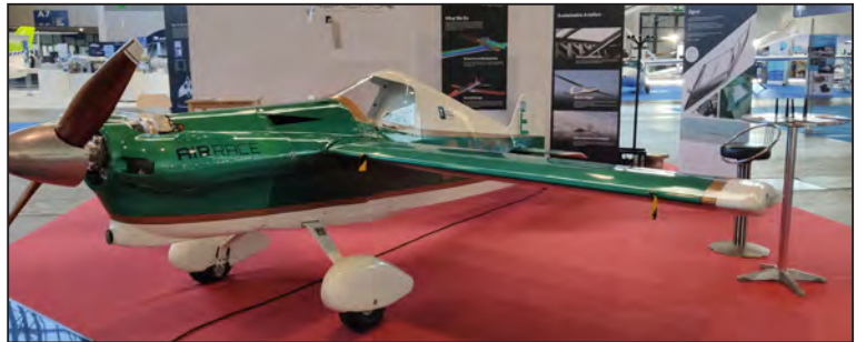
英国诺丁汉大学研制的计划参加电动飞机竞速赛（Air Race E）的电动竞速机，基于著名的美国 Cassutt 自制竞速机改装：
