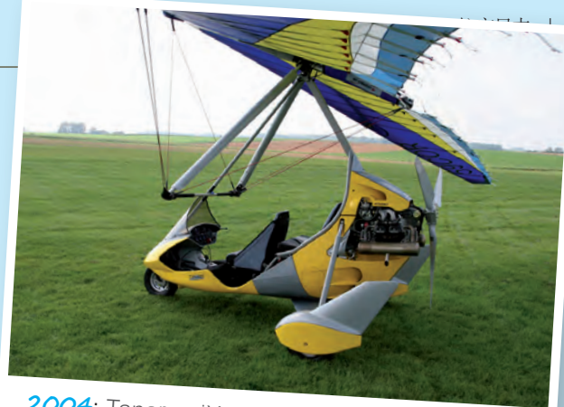
2004: Tanarg, iXess 机翼, 80 马力 Rotax 912 发动机, 焊接钢管构架。
