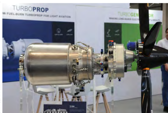
针对运动飞机开发的现代化的小型涡桨发动机 .....
