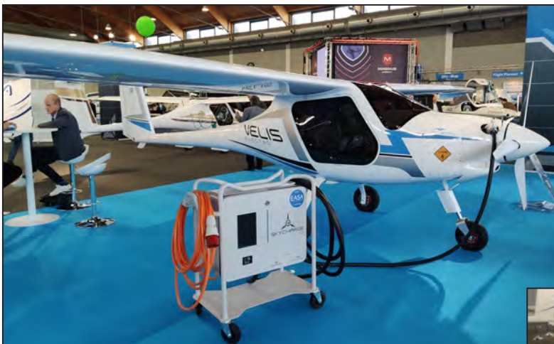
斯洛文尼亚蝙蝠飞机公司的 Velis 电动轻型运动飞机，这是首个取得 EASA 轻型运动飞机适航证的电动飞机。
