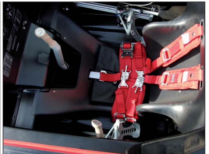
XA42 特技机采用五点式专用安全带，注意看腹部安全带采用双重配置，以确保安全
