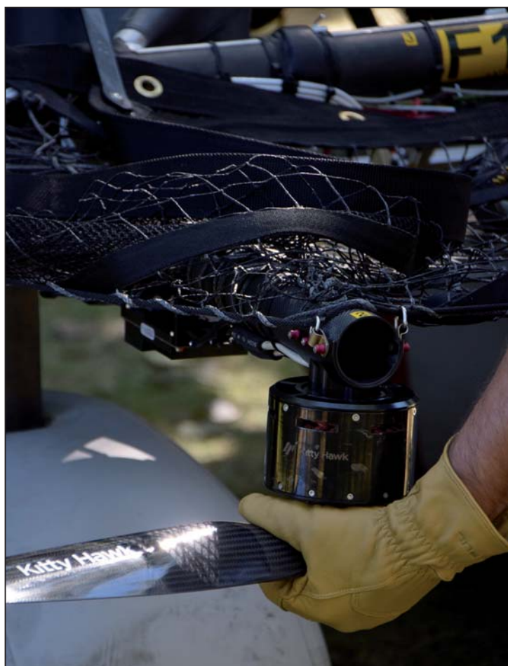
Kitty Hawk 自行研发的轻型电机和螺旋桨。
