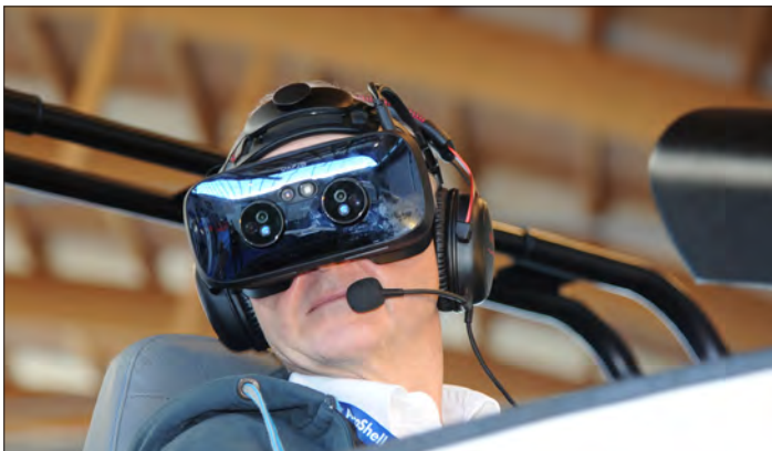
VR 眼镜，全方位视野；可以通过耳机与模拟器的操作员进行沟通。
