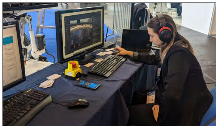
“真实模拟”：eVTOL 的原始控制软件在计算机上运行，然后将其输入发送到模拟程序。
