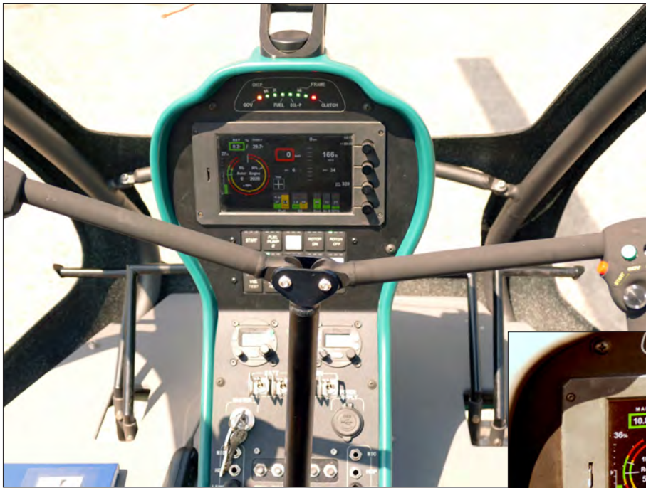
MGL Avionics 的大型 iEFIS 显示屏（电子飞行仪表系统）在仪表盘上占据主导地位，可单独编程。目前，它以不同的信息和警告颜色在一页上显示所有发动机转速、压力、温度和速度。例如，您可以通过按控制轮上的按钮切换到导航页面。
