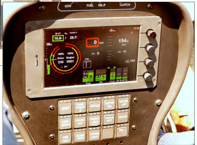
屏幕上方排列有 8 个 LED，指示状态管状框架中的燃料、机油、离合器、调速器、切屑检测器和气压。
