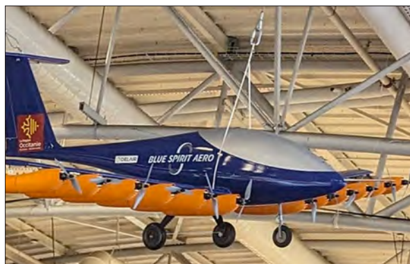
法国 Bluespirit 公司的设计：10 个分布式电推，有各自的氢燃料电池吊舱
