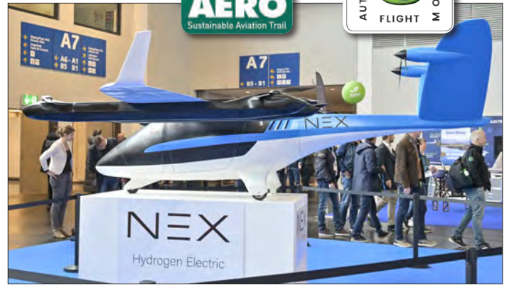
来自柏林的 Nex 展示了其燃料电池 eVTOL 的 50% 缩比模型，据称续航里程超过 500 公里。
