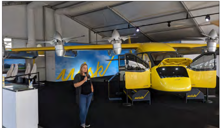
与在巴黎一样，Wisk 展示了其新型“第六代”空中出租车，该机为“倾斜旋翼”构型，其中六个前旋翼向上倾斜以进行垂直飞行。
