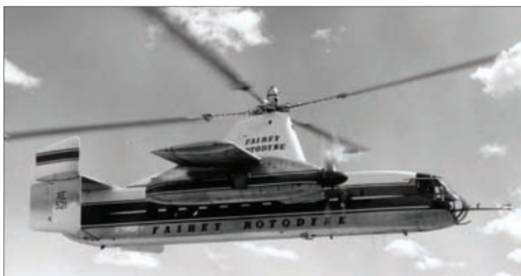
Fairy Rotodyne：这是有史以来最大的自转旋翼机，在旋翼末端有喷气推进系统。
