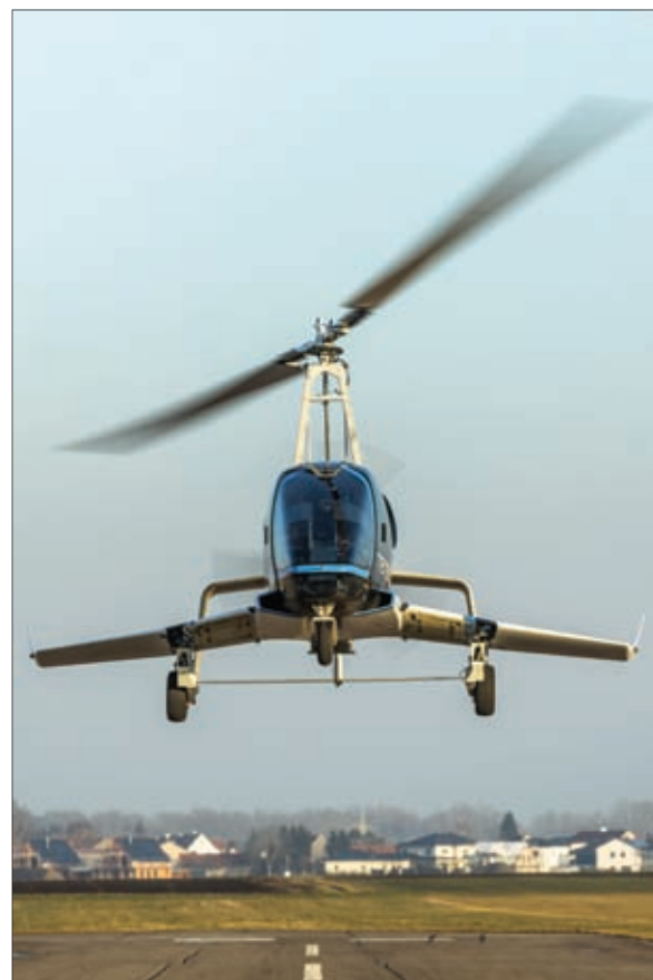
带短翼的旋翼机可以有更好的性能。昨天：这是一架美国的皮特凯恩旋翼机。
